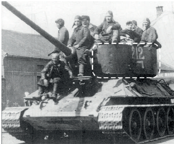
Il. 47 Czołg T-34-85 z 6. Korpusu Zmechanizowanego. Uwagę zwraca osłona przeciw pociskom kumulacyjnym na wieży.
