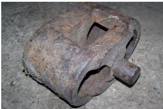
Il. 204 Element z zawieszania czołgu Pantera, wykorzystywany jako kowadło, Radomice 2013 r.
