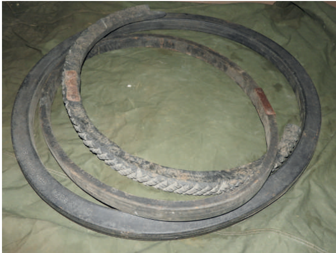
Il. 277 Opony do roweru wykonane z amortyzacji wewnętrznej z kół od czołgu Tygrys, Lisów 2019 r.
