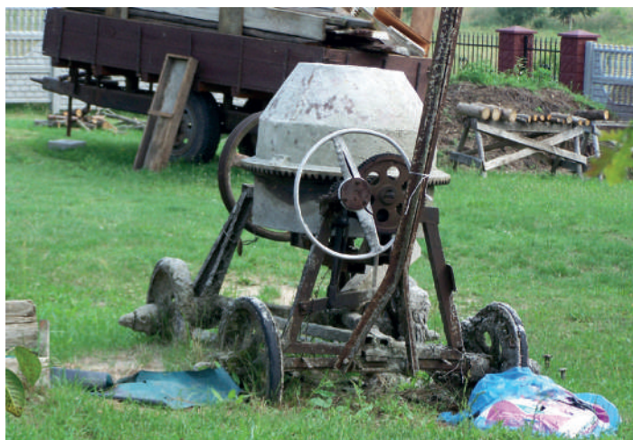
Il. 227 Betoniarka na kołach od niemieckiego transportera Sd.Kfz.251, Radomice 2013 r.
