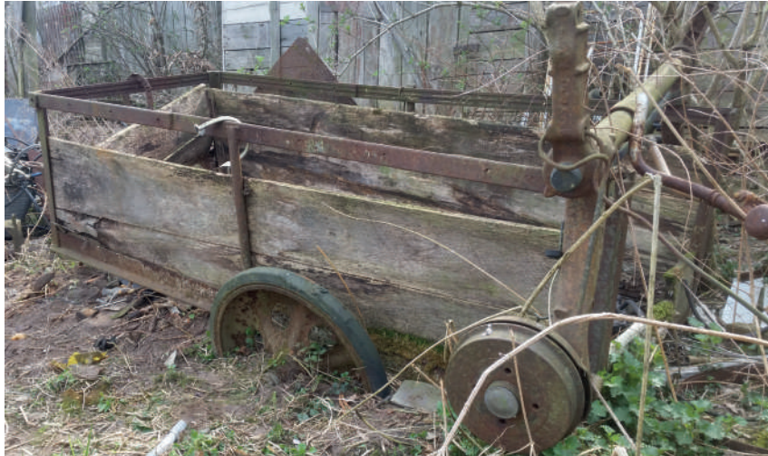
Il. 225 – Wóz na kołach od niemieckiego półgąsienicowego transportera opancerzonego Sd.Kfz.251.
