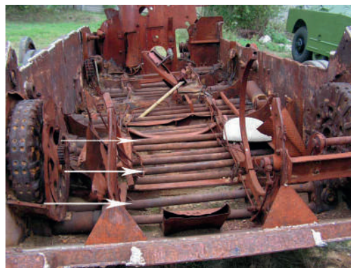
Il. 158 – Kadłub czołgu Pantera, widoczne drążki skrętne.
