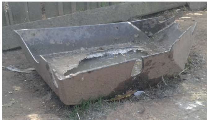
Il. 240 Dolne opancerzenie silnika od niemieckiego transportera Sd.Kfz.251, służące jako poidło, Radomice 2016 r.
