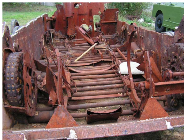
Wrak niemieckiego czołgu PzKpfw V Panther. Widoczne drążki skrętne.
